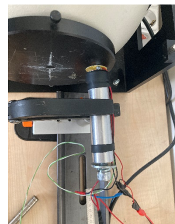
Abbildung 8: LED-Aufbau an Dosimeter und Ulbricht-Kugel
